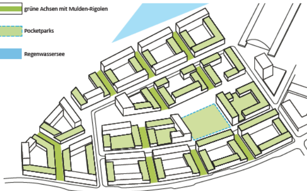
Abb. 6: Dezentrale Regenwasserbewirtschaftung in der Marktstadt Süd (westlicher Bereich)
